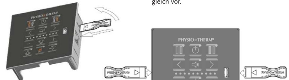
Abbildung 38: Ausbau des Bedienfeldes – erste Seite
